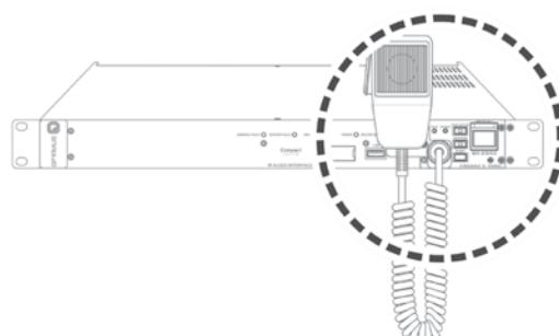
Se instala en el frontal de los interfaces IF y los amplificadores IP modulares IF-P
